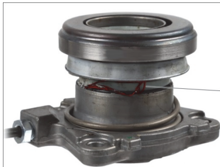
Fig. 2: Anel de vedação rasgado
