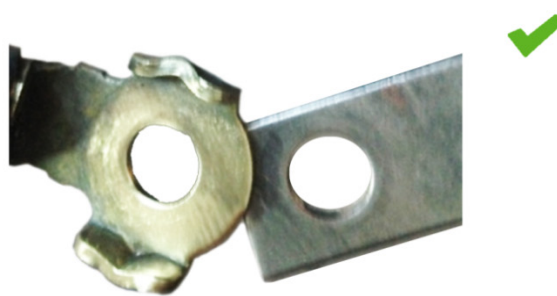
Fig. 2: Conexão da massa após a limpeza: bom contato
