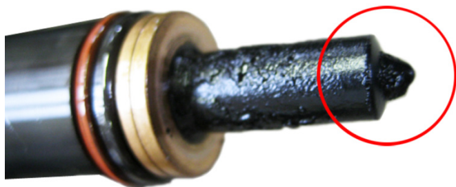
Fig. 3: Elemento da unidade de injetor carbonizado
