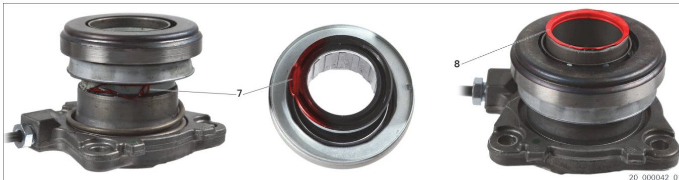
Rys. 2: Ścięty pierścień uszczelniający wargowy
