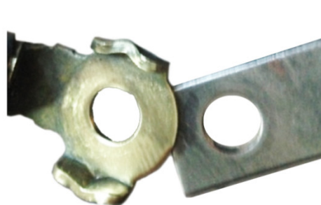
Rys. 2: Połączenie masy po wyczyszczeniu: dobry kontakt
