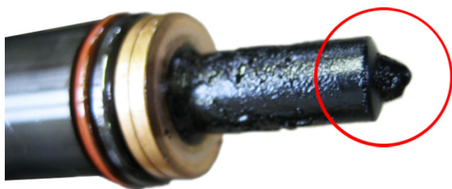
Rys. 3: Dysza pompy zanieczyszczona nagarem
