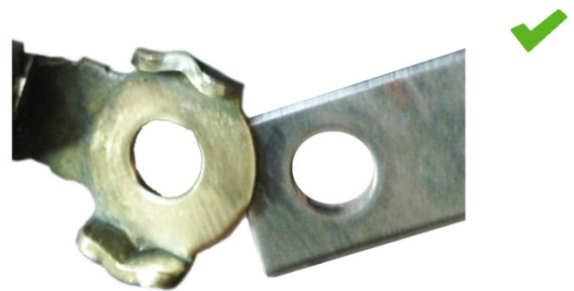
Afb. 2: Massaverbinding na de reiniging: contact goed
