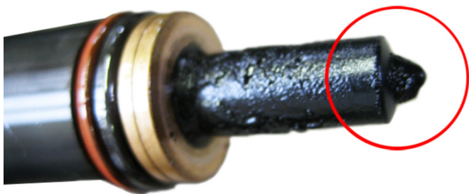
Fig. 3: ugello della pompa cokificato
