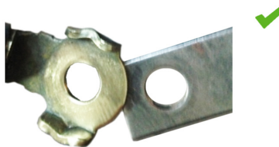
Fig. 2: collegamento di massa dopo la pulizia: contatto buono
