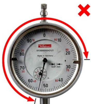
Fig. 3: eccentricità laterale \geq 0,5 mm
