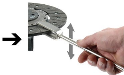
Fig. 4: regolazione del disco frizione
