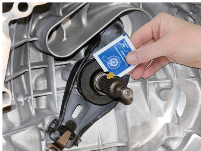
Fig. 2: Ingrassare leggermente tutto il profilo del mozzo dell'albero d'entrata del cambio
