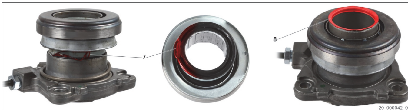
Fig. 2 : bague à lèvres cisailée
