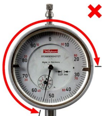
Fig. 3 : voilage \geq 0,5 mm
