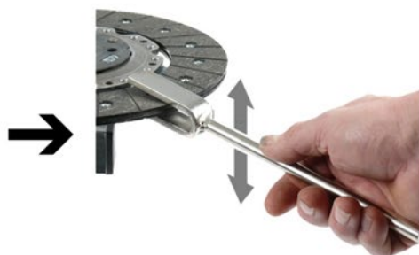
Fig. 4 : ajuster le disque d'embrayage
