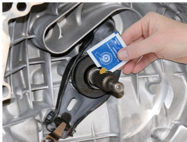
Fig. 2 : Graisser légèrement le profilé de moyeu de l'arbre d'entrée de la boîte de vitesse sur tout son pourtour.
