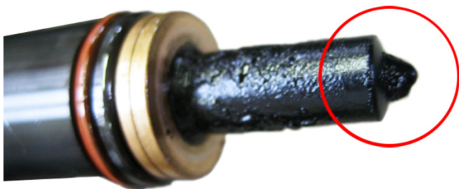
Fig. 3: elemento bomba-inyector carbonizado
