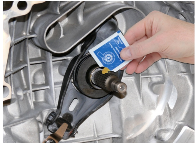
Fig. 2: Engrasar ligeramente el perfil del cubo del árbol de entrada de la transmisión por todas partes
