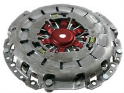
Fig. 1: Embrague autorregulador con pieza de bloqueo enclavamiento
