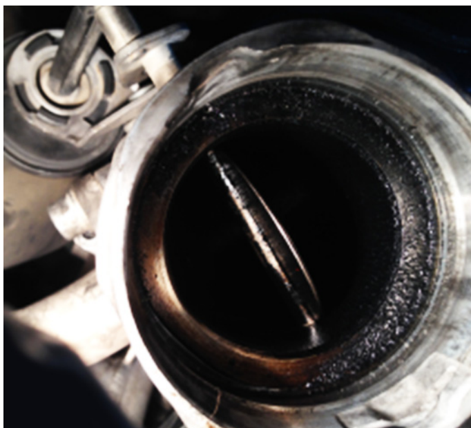
Abb. 4: Klappe des Abgasrückführungsventils (AGR-Ventil) verkocht
