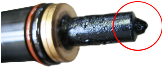
Abb. 3: Pumpe-Düse Element verkakt
