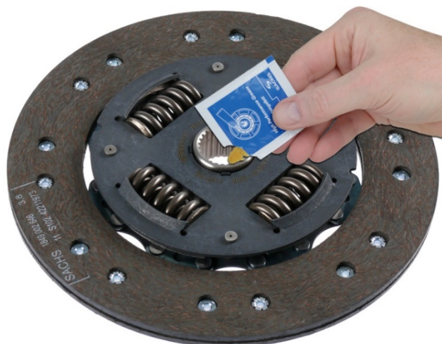
Abb. 1: Nabenprofil der Kupplungsscheibe rundum leicht fetten
